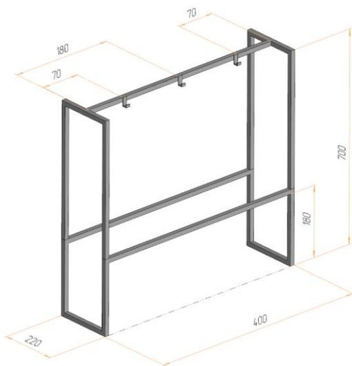
Сварная опора под настольную сушку для травы, или ее хранения их квадратной трубы 20x20мм;
